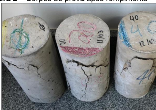
Figura 2 – Corpos de prova após rompimento
